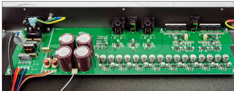
Links im Bild ist die Stromversorgung zu sehen. Mit auf der Platine befindet sich ein Netzfilter für den möglichst weit weg angeordneten Netztrafo
