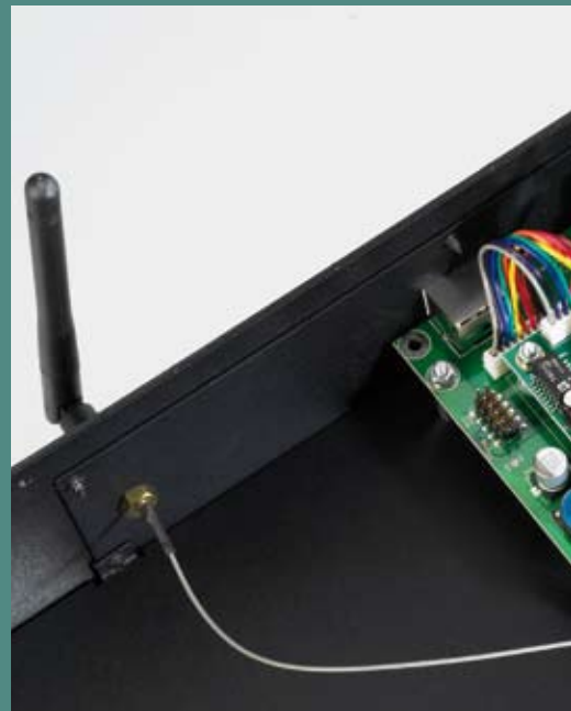
VERTRAUTER ANBLICK: Audio-Platinensandwich mit WLAN- (oben) und Streamingboard (darunter)
