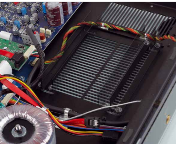
Die Halterungen für die interne Festplatte können verschoben werden, um 2,5- und 3,5-Zoll-Speicher zu beherbergen
