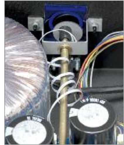
Über eine Achse miteinander verbunden: Lautstärkeanzeige und Motorpoti
