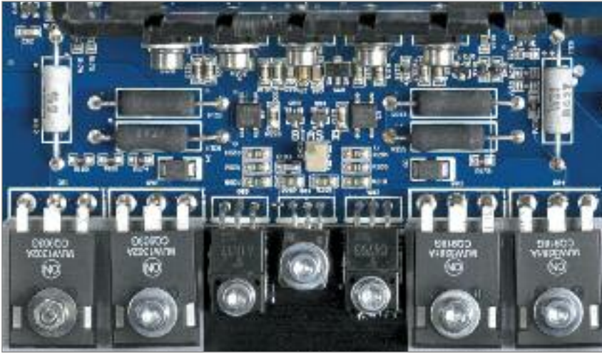
Üppige Reserven: Endtransistoren mit Treibern und Temperaturfühler. Ansonsten vertrauen die Norweger auch auf SMD-Technologie
